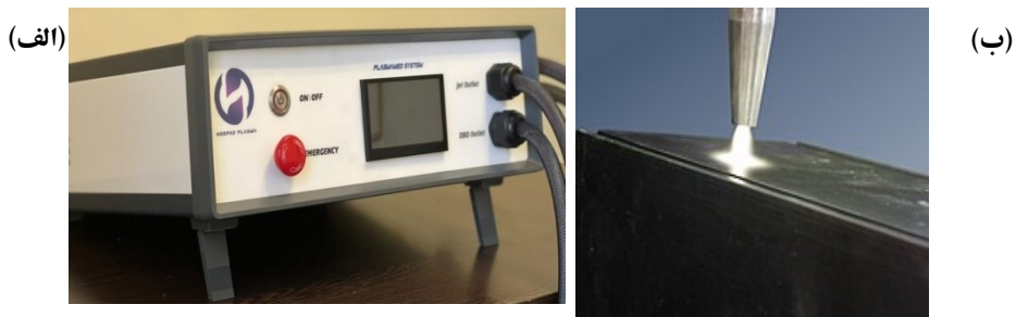
شکل ۳- الف: دستگاه پلاسمای سرد فشار اتموسفیری ب: نمای از جت پلازمای فشار اتموسفیری
